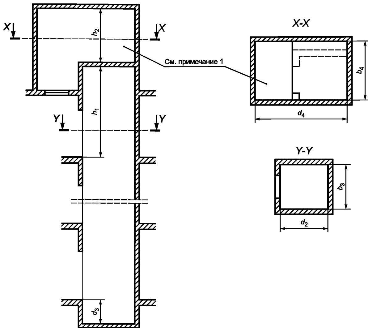
$b_3$  — ширина шахты;  $b_4$  — ширина машинного помещения;  $d_2$  — глубина шахты;  $d_3$  — глубина приямка;  $d_4$  — глубина машинного помещения;  $h_1$  — высота шахты от уровня верхней посадочной площадки до выступающих частей перекрытия над шахтой;  $h_2$  — высота машинного помещения
