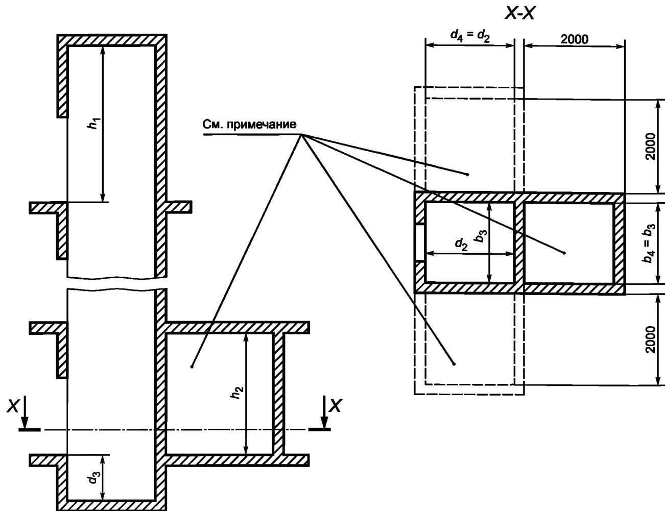
$b_3$  — ширина шахты;  $b_4$  — ширина машинного помещения;  $d_2$  — глубина шахты;  $d_3$  — глубина приямка;  $d_4$  — глубина машинного помещения;  $h_1$  — высота шахты от уровня верхней посадочной (погрузочной) площадки до выступающих частей перекрытия над шахтой;  $h_2$  — высота машинного помещения
