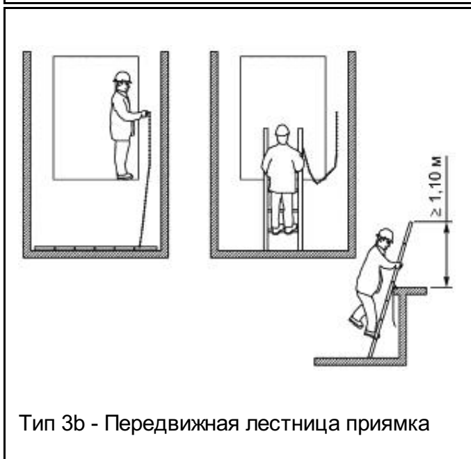
Рисунок С.1 - Типы лестниц доступа в приямок
